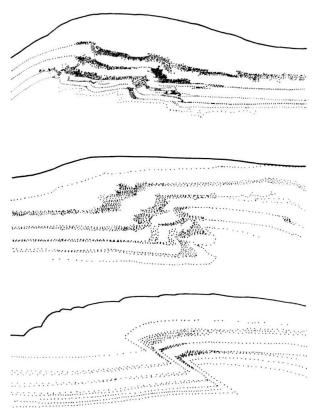
Fig. 25. Kompressive Deformation in Sanden verschiedenen Wassergehaltes nach Rettger (1935). Mit abnehmendem Wassergehalt (von oben nach unten) konzentriert sich die Deformation in einer zusehends schärfer definierten Scherzone. Dem Wassergehalt bei diesen Experimenten entspricht der Porendruck von Gesteinen im Untergrund.
