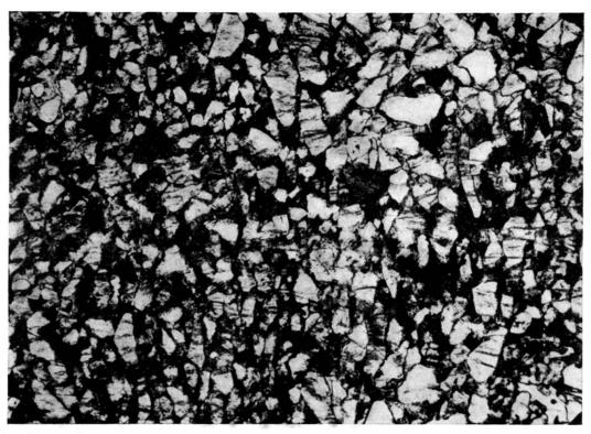
Fig. 20. Dünnschliff aus der unmittelbaren Nachbarschaft der Schnittebene von Fig. 19 mit verschiedenen Bewegungs- und Schersystemen. Durch die Bildmitte verläuft (von unten nach oben) die unscharfe Grenze zwischen einem grobkörnigen, helleren Bezirk (rechts) und einem etwas feiner gekörnten, dunkleren (links).  $30 \times$ .
