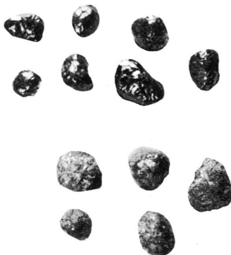
Fig. 17. Pisolithes à limonite de la surface préoligocène (en haut) et les mêmes corrodées et remaniées dans les latérites pliocènes (en bas) (Grand. nat.)
