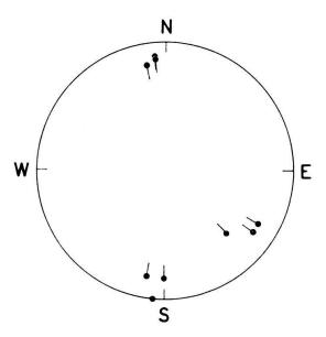
Fig. 2. Axes mesurés dans le Lias sup. sur le flanc E de la Pointe de l'Haut, reportés sur un canevas de Wulf (hémisphère supérieure). Les plis ont des amplitudes variant de 50 cm à 5 m. 9 mesures ont été prises sur une surface de 100 m² environ; 6 d'entre elles montrent des axes à peu près N-S, horizontaux ou presque (10° vers le N ou vers le S); les autres directions aberrantes semblent dues à du balancement superficiel.
