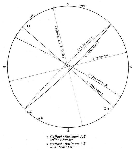
Fig. 11. Orientierung der mittleren Kluftlagen aus den Stereogrammen der Figuren 5 und 7, wenn die mittleren Schichtlagen in die Horizontale gedreht sind.
