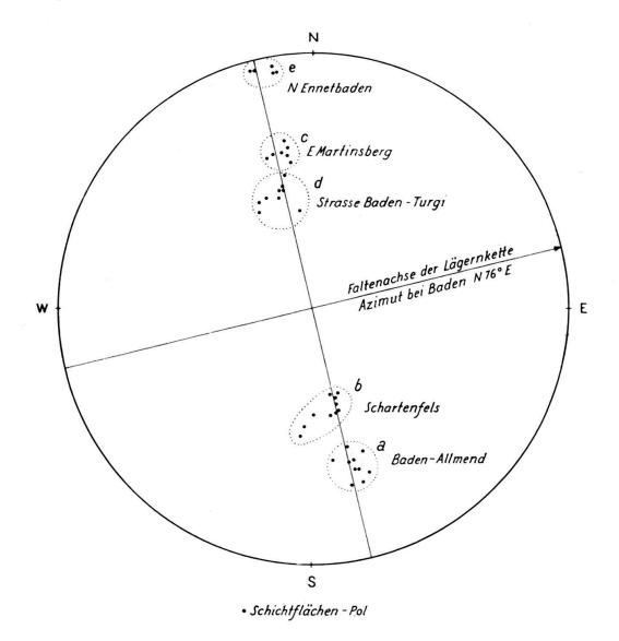
Fig. 2. Konstruktion der Faltenachse aus den Polen der Schichtflächen im Malm des N- und SSchenkels der Lägernkette bei Baden
