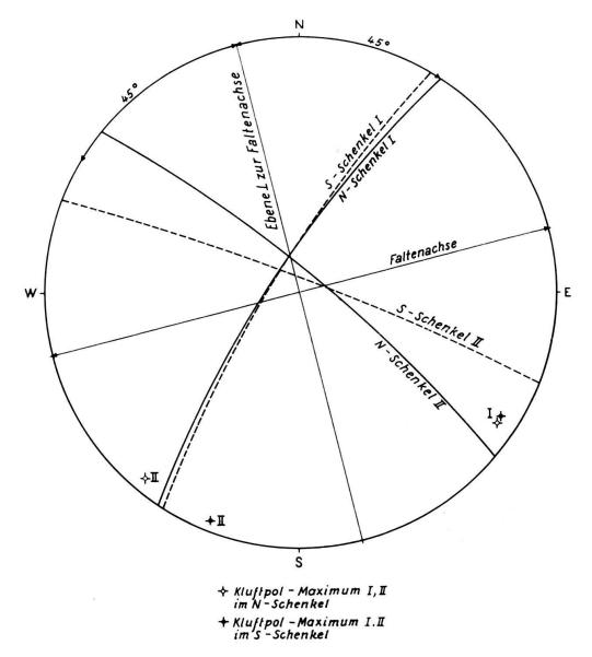
Fig. 10. Orientierung der mittleren Kluftlagen aus den Stereogrammen der Figuren 4 und 6, wenn die mittleren Schichtlagen in die Horizontale gedreht sind.
