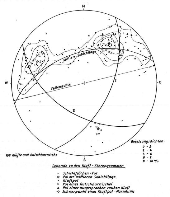
Fig. 4. Kluftstereogramm aus dem Aufschluss in den Geissbergschichten an der Strasse Baden-Allmend
