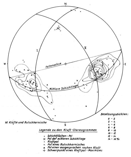
Fig. 6. Kluftstereogramm aus dem Aufschluss in der Übergangszone zwischen Geissberg- und Wangener Schichten; am Martinsberg
