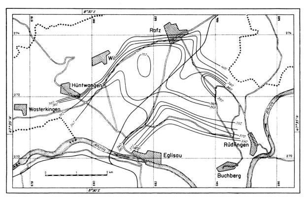
Fig. 1. Isohypsenkarte 1:75000 der Oberkante der Molasse des Rafzerfeldes nach geoelektrischen Messungen
