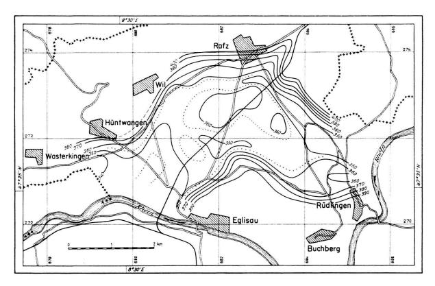
Fig. 2. Isohypsenkarte 1:75000 der Oberkante der Molasse des Rafzerfeldes nach seismischen Messungen
