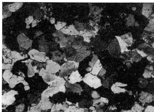
Fig. 5. Grès d'Espérance L.M. 2549 – Section perpendiculaire – Groupe d'Hénin-Liétard – Sondage 17 du Quai d'Annay à 201,23 m – Grès quartzitique – Westphalien B – Partie supérieure du faisceau de Pouilleuse – La presque totalité du champ est occupée par des grains de quartz. lum. polarisée X20
