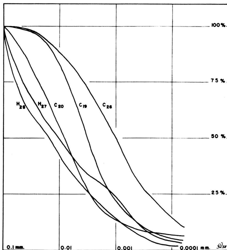
Fig. 5. Courbes granulométriques d'argiles du Chattien subalpin et de l'Helvétien
