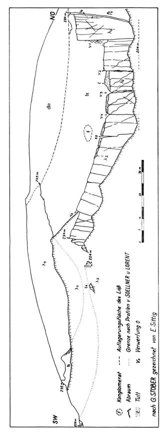
Fig. 1. Profil durch den Steinbruch 7 des Limberges am Kaiserstuhl, Maßstab 1:1000 (vgl. Fig. 2).
