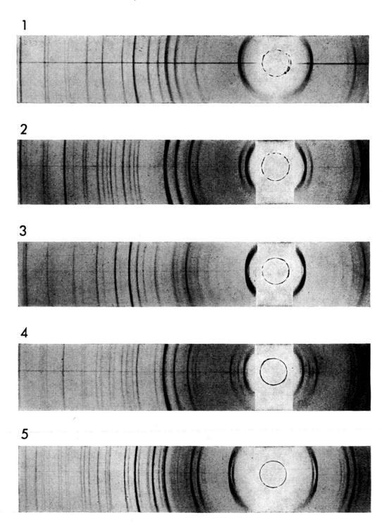
$\label{eq:Fig.1.Rontgenpulveraufnahmen.Fe-K-Strahlung (ungefiltert); Kameradurchmesser = 115,4\,\mathrm{mm}; \\ Röntgenaufnahmen in normaler Grösse reproduziert. Kamera Nonius, Delft, Holland.$
