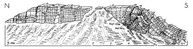
Fig. 14. Umbiegung im Hauptrogenstein 900 m W Stürmenkopf, 1,3 km NE Bärschwil. Die Klüfte sind in halbschematischer Form entsprechend ihrem wirklichen Verlauf eingezeichnet.
