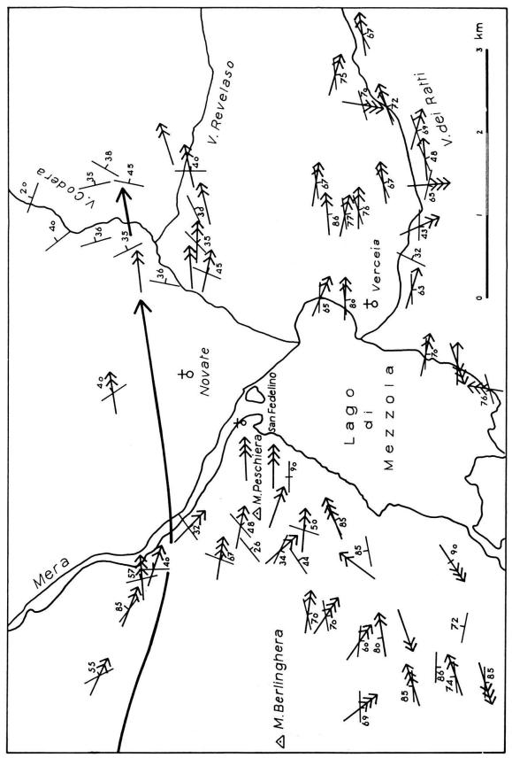
Fig. 2. Streichen und Fallen der s-Flächen, Verlauf der axial ostfallenden Antiklinale und der Lineationen im Gebiet Monte Peschiera-Lago di Mezzola-Codera. Maßstab 1:50000, Für die Achsen der Kleinfältelung und die übrigen Lineationen gilt die Legende von Figur 1.
