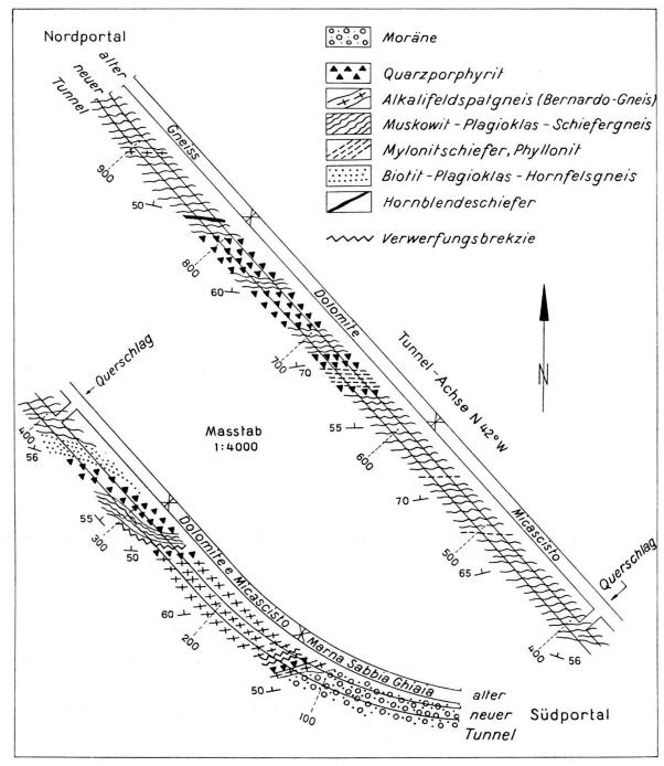
Fig. 2. Geologische Aufnahme 1:4000 des Massagnotunnels bei Lugano.
