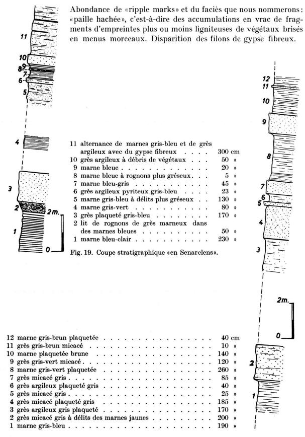
Fig. 20. Coupe stratigraphique légèrement en amont du pont du chemin allant de Vaux à Vufflens.
