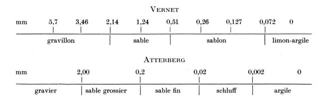
Une prise de chaque échantillon fut donc tamisée et une courbe granulométrique fut établie, ainsi qu'une courbe cumulative. Cette dernière permet une comparaison plus aisée des résultats des divers échantillons.
