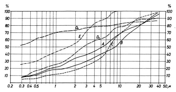
Fig. 2. Ergebnisse der Sedimentationsanalyse der untersuchten Bentonite in Summenkurvendarstellung. A Bischofszell, obere Schicht, B Bischofszell, untere Schicht, C Jonentobel,  $D_1$  Heilsberg unbeh.,  $D_2$  Heilsberg, behandelt mit Na $_2$ CO $_3$  (3%), E Heiligenberg. Mit Ausnahme von  $D_2$  alle Bentonite im natürlichen Zustand.
