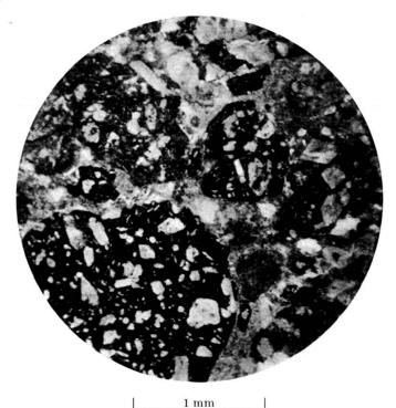
Fig. 3. Dünnschliffbild des Lapillituffs vom Karolihof. Lapilli mit  $\pm$  idiomorphen Olivineinsprenglingen und kleinen Augitleistchen in karbonatisch-zeolithischer Grundmasse. Einf. pol. Licht. Aufnahme F. Hofmann.
