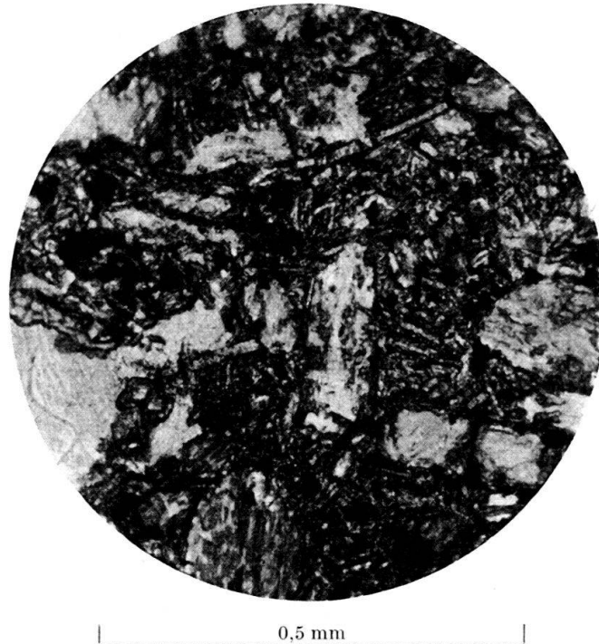
Fig. 2. Dünnschliffbild des Basaltes von Ramsen. Grundmasse aus Augitleisten. Mitte: Melilithkristall. Links unter der Mitte: karbonatische Blasenfüllung. Rechts unter der Mitte und unten: Olivine. Einf. pol. Licht. Aufnahme F. Hofmann.
