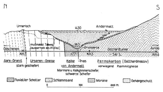
Fig. 4. Geologisches Profil 1:20000 durch das Andermatter Becken, in der Achse des Gotthardtunnels (nach E. Meyer-Peter, Th. Frey, A. Kreis und R. U. Winterhalter, 1945).
