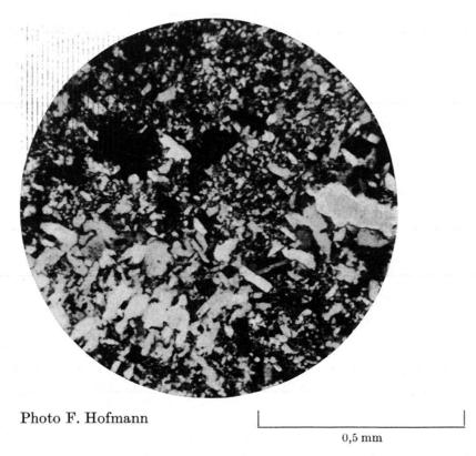
Fig. 2. Typisches Dünnschliffbild des Silexites des Dürrschrennen-Gebietes, Nicols x. Feinkörnige, isometrisch ausgebildete Quarzkriställchen als «Grundmasse», mit Schlieren grösserer, sperriger Quarze.
