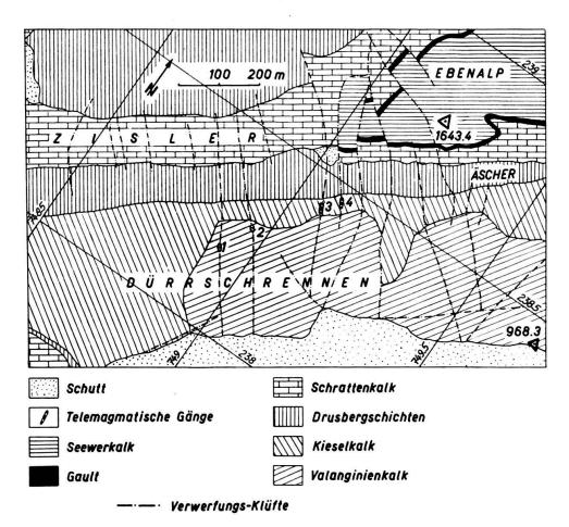
Fig. 1. Geologische Situationsskizze der telemagmatischen Gänge von Dürrschrennen, Maßstab 1:12500.
