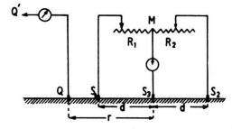
Fig. 10. Messanordnung der RACOM-Methode.
