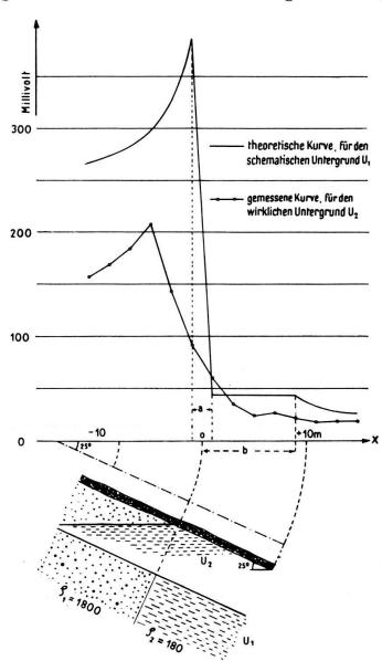
Fig. 14. Verlauf der Potentialdifferenz  $\Delta$  über einer Unstetigkeitsfläche bei 3 mobilen Elektroden (alle Werte auf J/2  $\pi$   $\varrho_1 = 10$  normiert).
