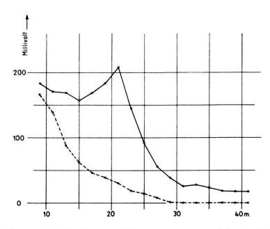
Fig. 19. Beispiel des Verlaufs der Potentialdifferenz, gemessen nach der kombinierten Methode (siehe Fig. 20, Profil T).
