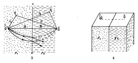
Fig. 3. Die Punktquelle gegenüber einer ebenen Unstetigkeitsfläche (Spiegelungsmethode).  $Q = \text{Punktquelle}; \ \overline{Q} = \text{Spiegelbild der Punktquelle}.$
