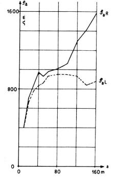
Fig. 17. Scheinbare spezifische Widerstände über Untergrund mit geneigter Schichtgrenze.
