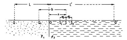
Fig. 12. Die Elektroden im Halbraum mit Unstetigkeitsfläche.
