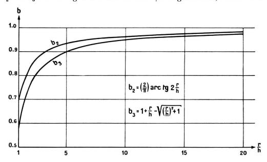
Fig. 5. Darstellung der Faktoren b2 und b3 in Funktion von r/h.
