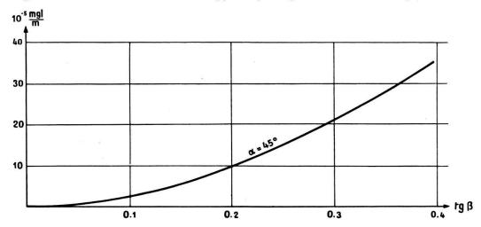
Fig. 3b. Beitrag eines Zylinderhufsektors mit dem Öffnungswinkel  $\alpha = 45^{\circ}$  in Funktion von tg  $\beta$ .
