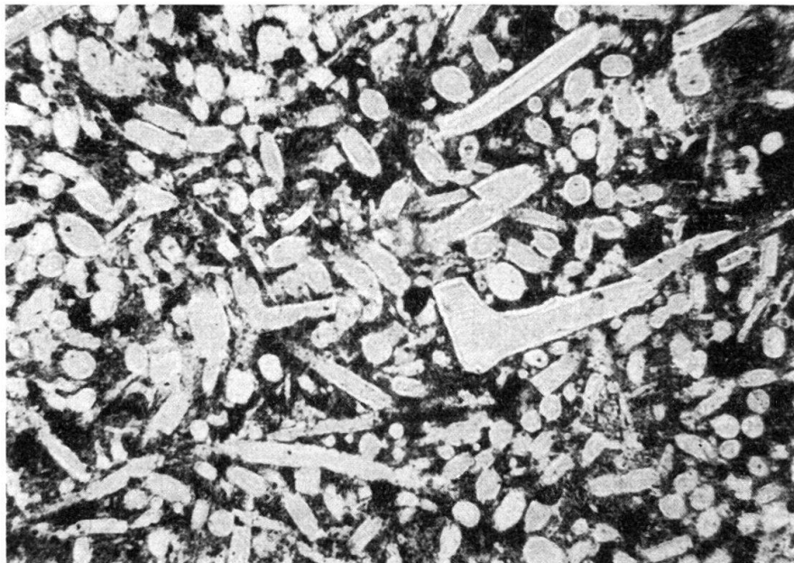
Fig. 4. Galet L 10, station de Baumaroché II. Spongolithe ; spicules calcédonieux dans une gangue calcaréo-cherteuse. 36:1, lumière naturelle.
