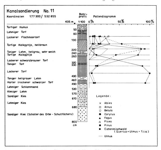
Fig. 2. Bohrprofil in den Grands-Marais d'Orbe, Masstab 1:100.
