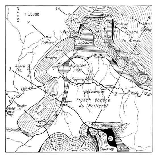
Fig. 1. Carte géologique au  $1:50\,000$ . Aal. = Aalénien - Tr. = Calcaire du Trias - G. = Gypse du Trias. 1 à 5 situation des coupes.
