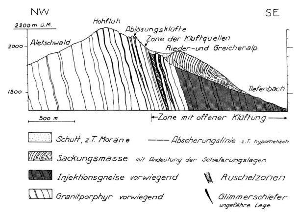
Fig. 2. Geologisches Querprofil Hohfluh-Greicheralp-Tiefenbach, 1:25000, schematisch.
