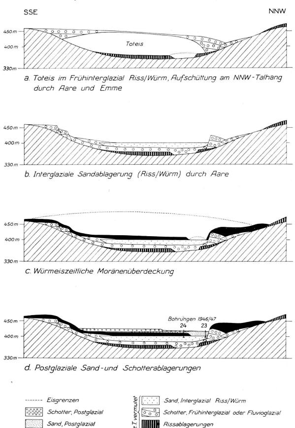
Fig. 5. Entwicklungshypothese des Quartärs im Becken von Luterbach-Wangen a. A., schematisch, Überhöhung 4:1.
