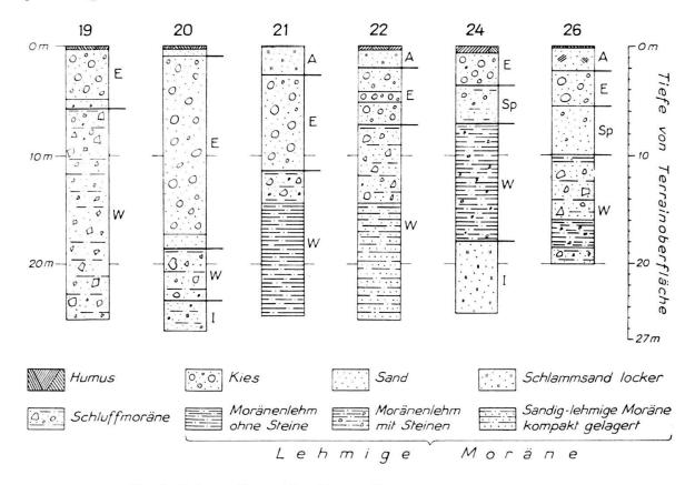
Fig. 2. Bohrprofile aus dem Raume Bernerschachen-Hohfuhren, vereinfachte Fassung.
