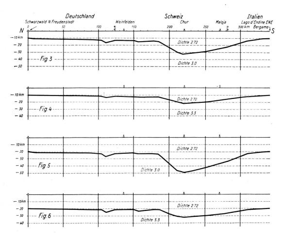
Fig. 3—6. Aus Schweremessungen bestimmter Verlauf der Hauptunstetigkeitsfläche unter den Alpen nach verschiedenen Annahmen.
