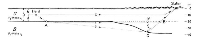
Fig. 1. Schematisches Profil durch die Erdkruste in der Nähe einer Gebirgskette. 1 Weg der Pn-Welle zur Flachlandstation. 2 Weg der Pn-Welle zur Gebirgsstation. 3 Weg der  $P_q$ -Welle zur Station (vgl. Tab. 6).
