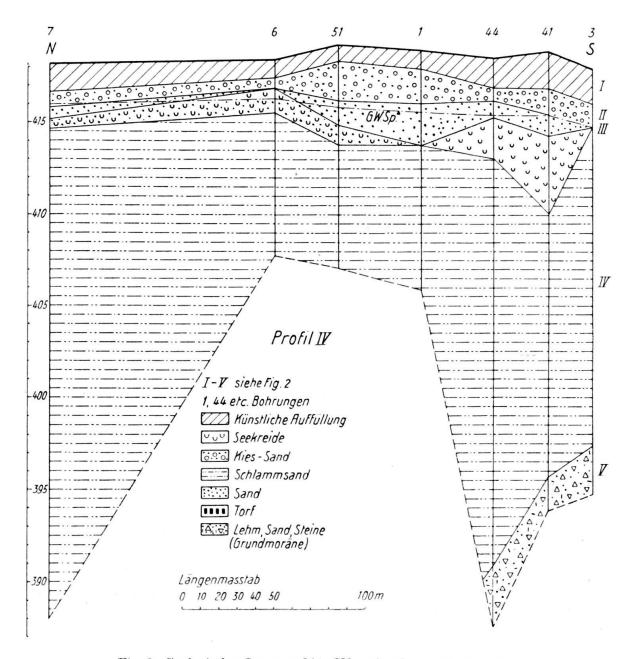
Fig. 3. Geologisches Längsprofil in Ufernähe (Lage siehe Fig. 1).
