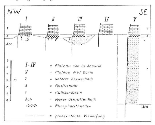
Fig. 3. Detailprofile in der Mittleren Kreide bei La Saourie, Rawilgebiet.
