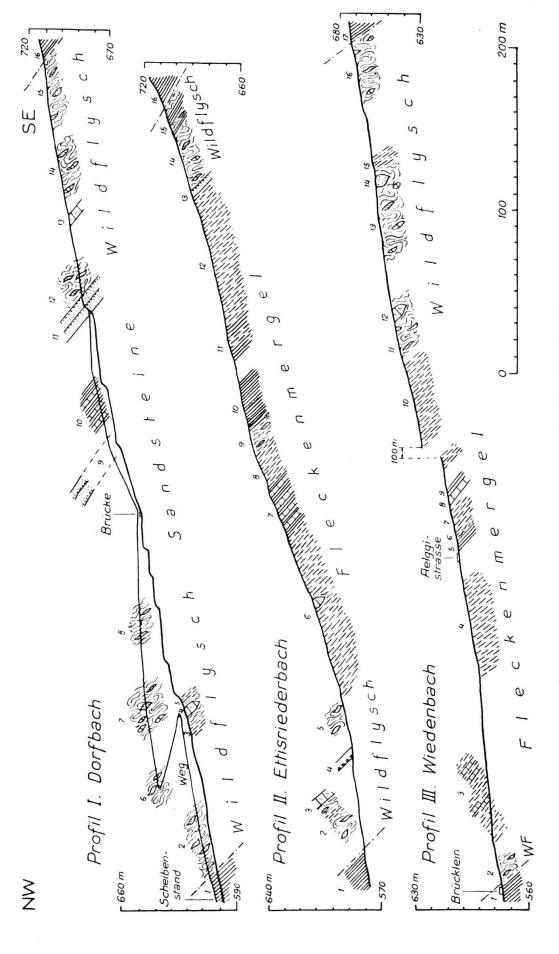
Fig. 10. Detailprofile durch die Sachsler Flyschmulde.
