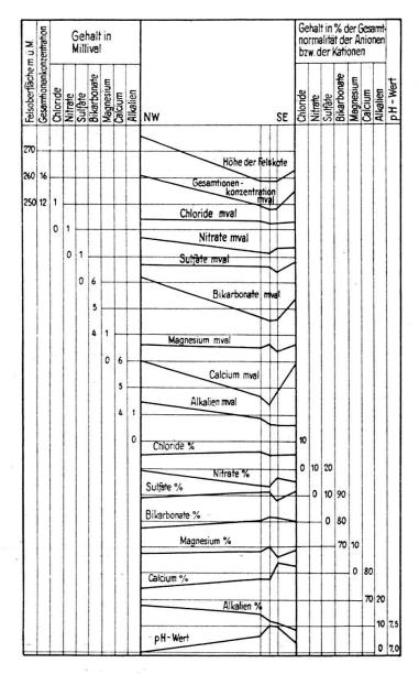
Fig. 2. Chemisches Querprofil durch den Grundwasserstrom des Birstales bei Münchenstein.
