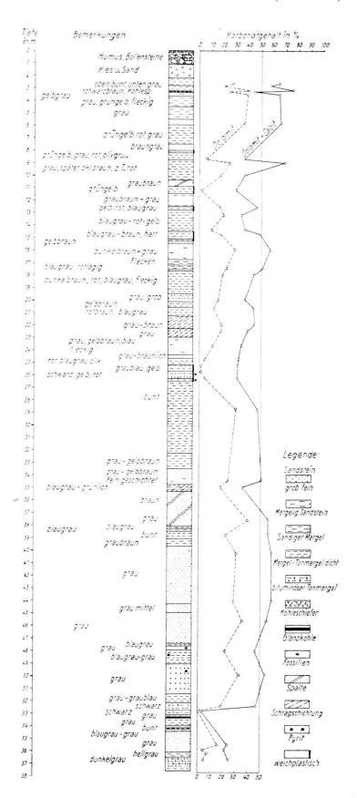
Fig. 3. Bohrprofil Bohrung Nr. 2 bei Sihlbrugg (Kt. Zürich).
