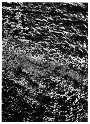
Fig. 8. Anschl., 14:1. Kohle aus der Hauptverwerfung (No. 7) im Schrattenkalk, Grundstrecke, Kote1777.Brackwasserkalkeinschluss(grau), randl. in ein Netzwerk aufgelöst, das die Kohle (dunkel mit hellen Reflexionsrändern) durchsetzt.
