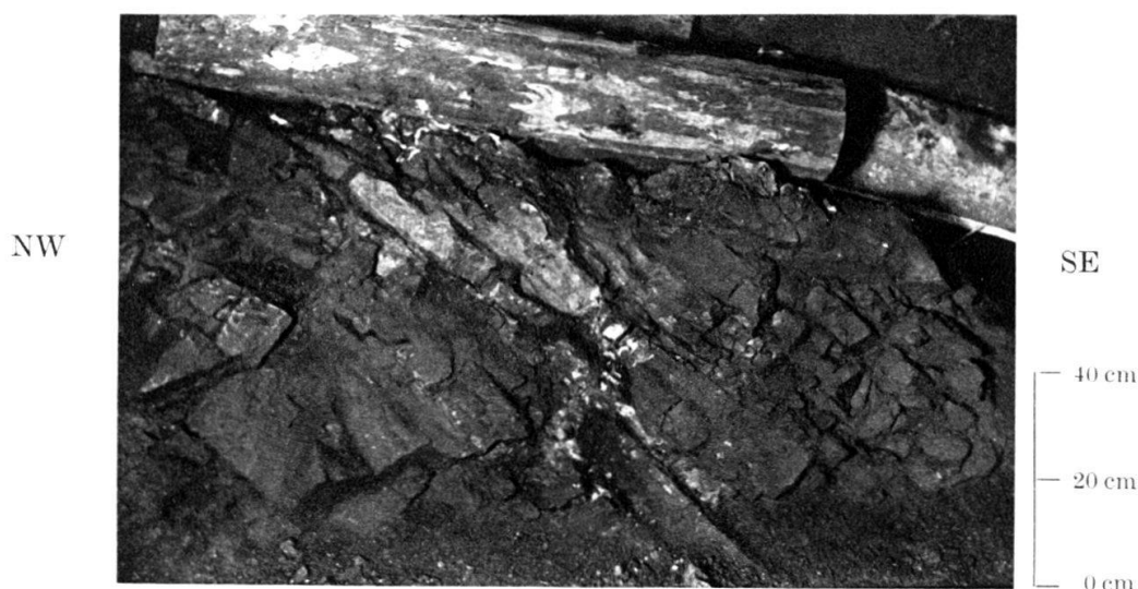
Fig. 2. Kohlenführende Verwerfung (Hauptverwerfung No. 9) zwischen Drusbergschichten (im Vordergrund) und Schrättenkalk. Aufnahme senkrecht zum Streichen der Verwerfung, welche mit 45^{\circ} bis 50^{\circ} nach NE einfällt und im obern Drittel des Bildes angeschnitten ist. Die beiden Einbauhölzer geben den Verlauf derselben, sowie der Kohle an, über welcher Schrättenkalk liegt (s. auch Fig. 3). — Aufn. in Grundstrecke 1803 bei Aufbruch 3. Phot. R. Schaer.
