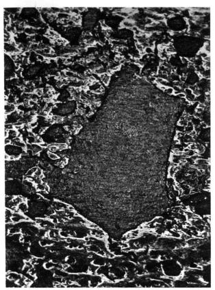
Fig. 5. Anschl., 21:1. Brackwasserkohle, Abbau-Feld 21-N, Kote 1806. Einschluss von Brackwasserkalk (dunkelgrau) mit beginnenden Korrosionserscheinungen; Kohle metallisch glänzend mit hellen Reflexionsrändern.
