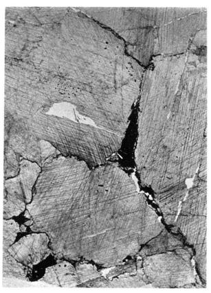
Fig. 11. Dünnschl., 10:1. Gross-spätiger Kalk aus dem Kontakt des Schrattenkalkes mit Verwerfung, Grundstrecke I—N, Kote 1837, bei Abzweigung nach Gesenk II. Kohle randlich und auf den Interstizien der grossen Calcitkörner.
