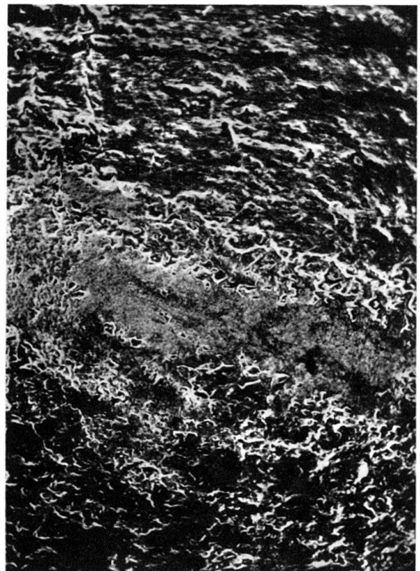
Fig. 8. Anchl., 14:1. Kohle aus der Hauptverwerfung (No. 7) im Schrattenkalk, Grundstrecke, Kote 1777. Brackwasserkalkeinschluss (grau), randl. in ein Netzwerk aufgelöst, das die Kohle (dunkel mit hellen Reflexionsrändern) durchsetzt.
