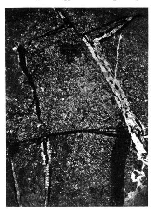
Fig. 1. Dünnschl., 24:1. Brackwasserkalk, Grundstrecke II-N, Kote 1797. Calcitisch-kohlige, z. T. symmetrische Gänge; Kohle sowohl lateral als auch zentral. Unregelmässig verästelte Kohlen-Infiltrationen.
