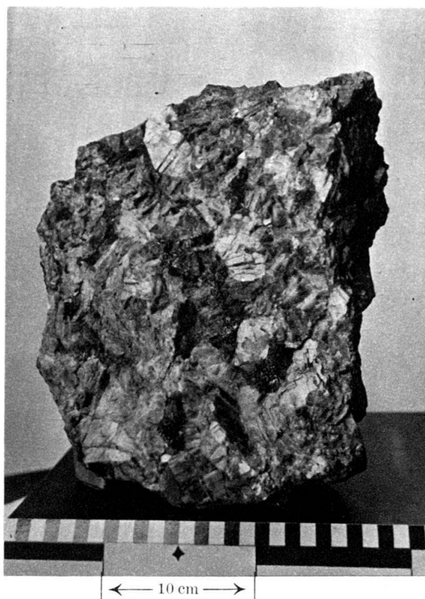
Fig. 5. Derselbe Block wie Fig. 4. Gross-spätiger Schrägkalk mit bis 5 cm grossen Kalkspatkörnern. Dazwischen Nester und Infiltrationen von Kohle (schwarz bis dunkelgrau).
