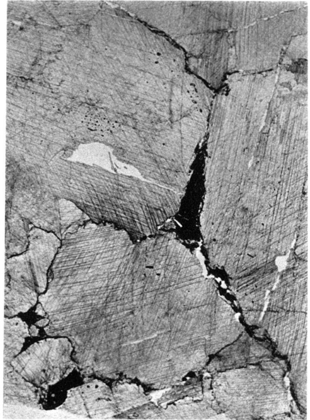
Fig. 11. Dünnschl., 10:1. Gross-spätiger Kalk aus dem Kontakt des Schrägkalkes mit Verwerfung, Grundstrecke I—N, Kote 1837, bei Abzweigung nach Gesenk II. Kohle randlich und auf den Interstizien der grossen Calcitkörner.
