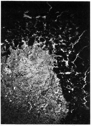
Fig. 6. Dünnschl., 24:1. Kohle aus der Hauptverwerfung (No. 7) im Schrattenkalk, Grundstrecke, Kote 1777. Einschluss von Brackwasserkalk, randl. aufgelöst in schwammiges Netzwerk. Rechter Bildrand: kalkige Substanz auf feinem Riss-System.
