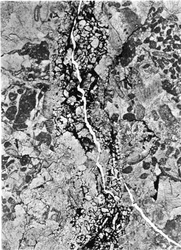
Fig. 10. Dünnschl., 10:1. Schrägkalkblock aus der Kohle der Verwerfung (No. 9) im Kontakt mit Drusbergschichten, Abbau-Feld Gx-2. Breckziöse Kluftfüllung mit kohligem Zement; Kohle auch auf Rissen und fetzenförmig zwischen Calcitkörnern; Schrägkalk z. T. tektonisiert.
