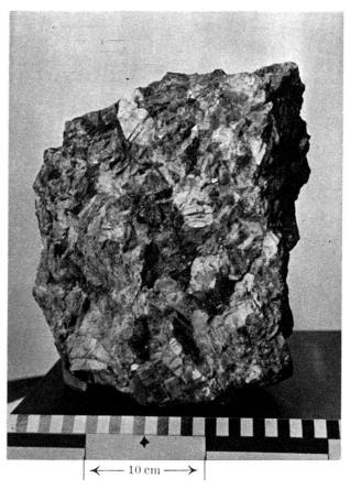
Fig. 5. Derselbe Block wie Fig. 4. Gross-spätiger Schrattenkalk mit bis 5 cm grossen Kalkspatkörnern. Dazwischen Nester und Infiltrationen von Kohle (schwarz bis dunkelgrau).
