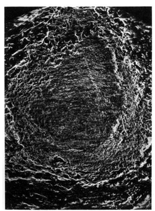
Fig. 7. Anschl., 14:1. Kohle aus der Hauptverwerfung (No. 7) im Schrattenkalk, Grundstrecke, Kote 1777. Brackwasserkalkeinschluss mit dunklerem, dichtem Kern und aufgelockerter Randzone mit Reaktionshof.
