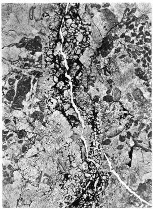
Fig. 10. Dünnschl., 10:1. Schrattenkalkblock aus der Kohle der Verwerfung (No. 9) im Kontakt mit Drusbergschichten, Abbau-Feld Gx-2. Breckziöse Kluftfüllung mit kohligem Zement; Kohle auch auf Rissen und fetzenförmig zwischen Calcitkörnern; Schrattenkalk z. T. tektonisiert.
