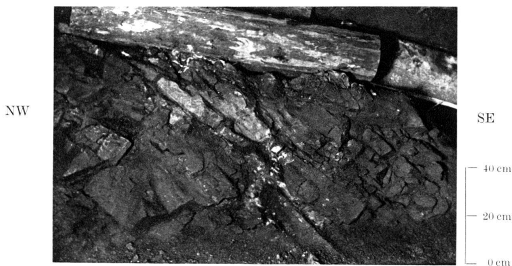
Fig. 2. Kohlenführende Verwerfung (Hauptverwerfung No. 9) zwischen Drusbergsschichten (im Vordergrund) und Schrätkalk. Aufnahme senkrecht zum Streichen der Verwerfung, welche mit 45^{\circ} bis 50^{\circ} nach NE einfällt und im obern Drittel des Bildes angeschnitten ist. Die beiden Einbauhölzer geben den Verlauf derselben, sowie der Kohle an, über welcher Schrätkalk liegt (s. auch Fig. 3). — Aufn. in Grundstrecke 1803 bei Aufbruch 3. Phot. R. Schaer.
