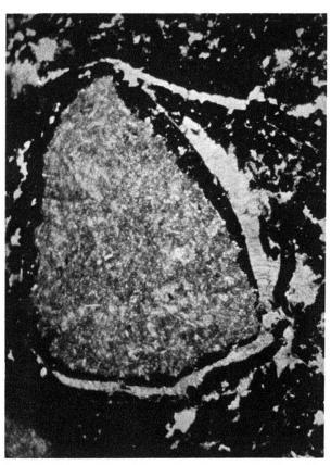
Fig. 4. Dünnschl., 46:1. Brackwasserkohle, Abbau-Feld 21-N über Grundstrecke II-N, Kote 1806. Einschluss von Brackwasserkalk, von Kohle und Calcit gangsymmetrisch umhüllt.
