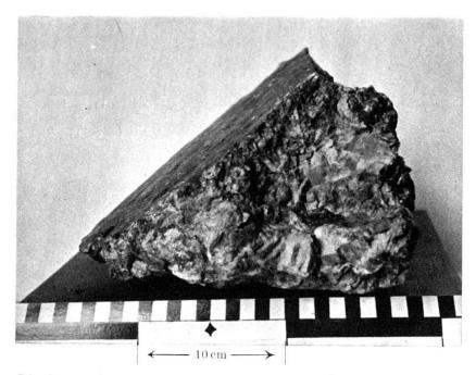
Fig. 4. Gross-spätiger Block von Schrattenkalk mit Rutschharnisch (Kohlenspiegel) aus Hauptverwerfung No. 9. Entnahmestelle siehe Fig. 3 (Bildmitte oben rechts, am Kontakt des Kalkes mit Kohle der Verwerfung).
