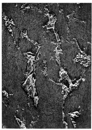
Fig. 3. Anschl., 14:1. Brackwasserkalk, Abbau-Feld Dx-10 über Grundstrecke II-S, Kote 1808. Kalkige, kohlig durchstäubte Grundsubstanz mit Nestern und tropfenartigen Einschlüssen von Kohle (Randreflexe).
