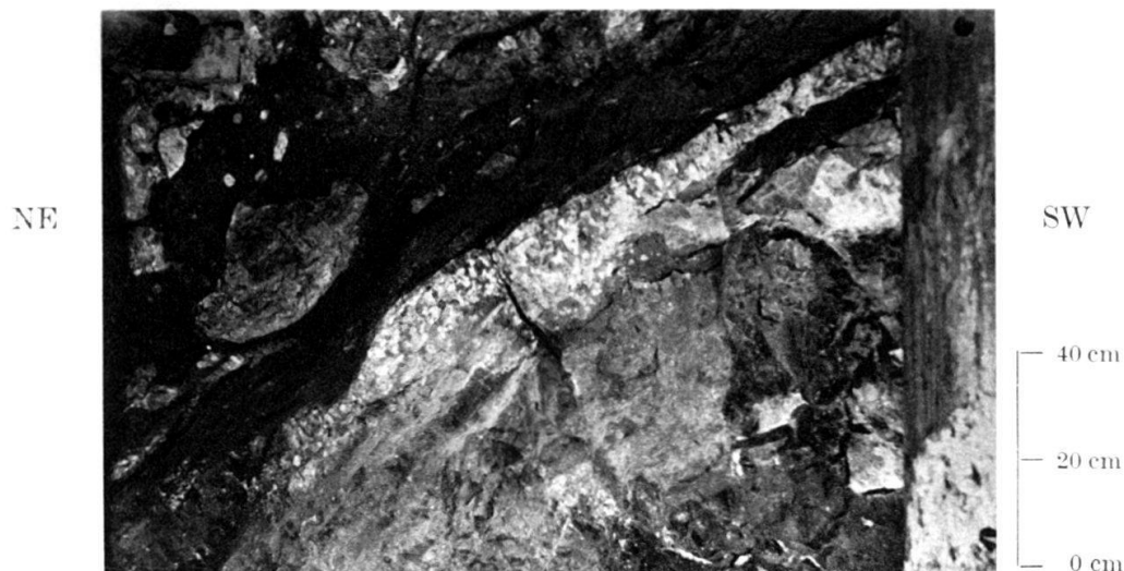
Fig. 1. Kohlenführende Verwerfung (Hauptverwerfung No. 7) zwischen zwei Schollen von Schrätkalk mit Kalkspatisierung des letztern parallel zum Verwerfungskontakt. Kohlensubstanz erscheint auch als Füllmaterial von kleinern Rissen und Spalten im Schrätkalk selbst. — Aufn. im Hauptquerschlag Kote 1797 bei 120 m ab Stollenmundloch. Phot. R. Schaer.
