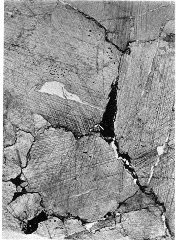
Fig. 11. Dünnschl., 10:1. Gross-spätiger Kalk aus dem Kontakt des Schrägkalles mit Verwerfung, Grundstrecke I—N, Kote 1837, bei Abzweigung nach Gesenk II. Kohle randlich und auf den Interstizien der grossen Calcitkörner.
