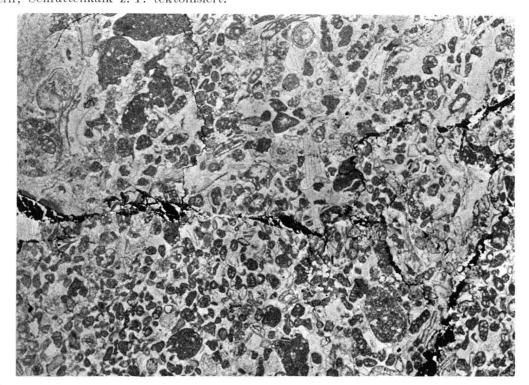
Fig. 9. Dünnschliff, 10:1 Schrattenkalk in der Nähe der Hauptverwerfung (No. 7), Grundstrecke, Kote 1777. Infiltration von Kohle und Calcit. Am linken Bildrand Risse in der Kohle calcitisch verheilt.
