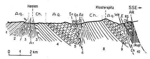
Fig. 2. Schematisches Übersichtsprofil durch die appenzellische subalpine Molasse.
