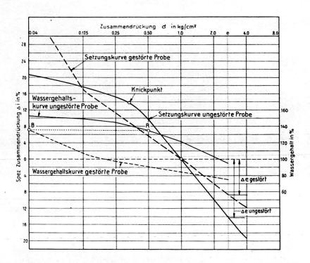
Fig. 6. Zusammendrückungsdiagramm einer ungestörten und einer gestörten Seekreideprobe.
