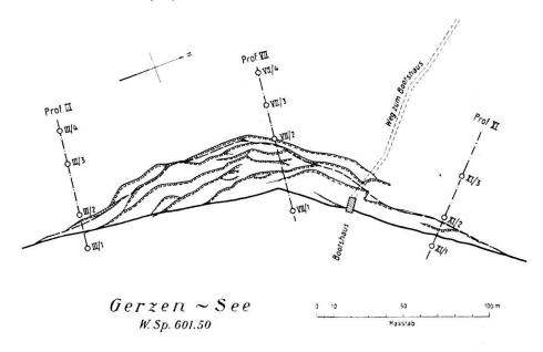
Fig. 2. Situation der Einbruchstelle mit altem und neuem Seeufer, Verlauf der Spalten und Entnahmestellen der Bohrproben.
