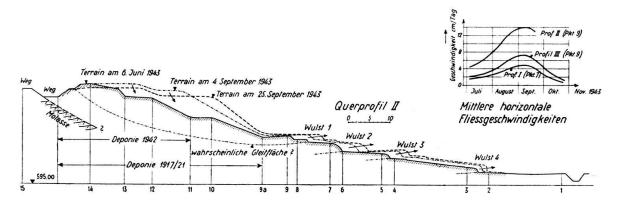
Fig. 7. Profil durch die Deponierutschung.
