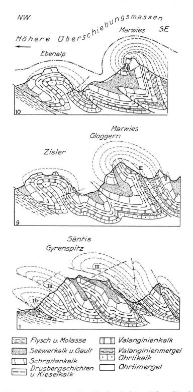
Fig. 5. Theoretisch ergänzte Profile durch das mittlere Säntisgebirge. 1:60000.
