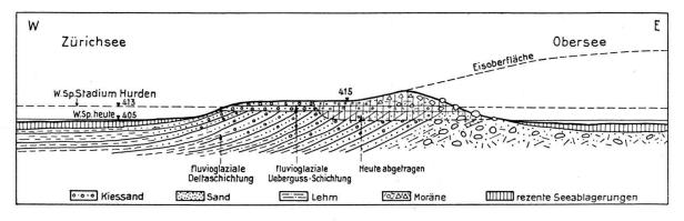
Fig. 2. Schematische Darstellung der Bildung des Quer-Oses von Hurden.
