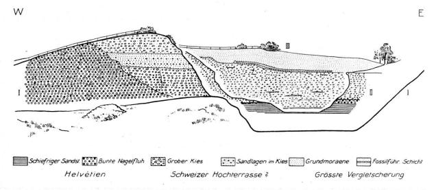
Fig. 2. Skizze der Lagerungsverhältnisse in der Kiesgrube Gumi bei Rohrbach. Nach einer photographischen Aufnahme vom 3. Sept. 1940 gezeichnet. Kulisse I: Südlicher Teil; II: Mittlerer Teil; III: Nordwand der Grube.
