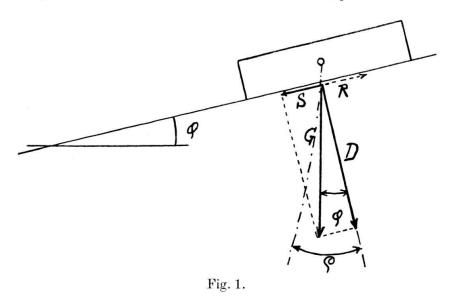
G ist das Gewicht der auf der Böschung ruhenden Masse, S deren Schubkraft =  $G \sin \varphi$ , D ist der Druck normal auf die schiefe Unterlage (Normaldruck) =  $G \cos \varphi$ .
