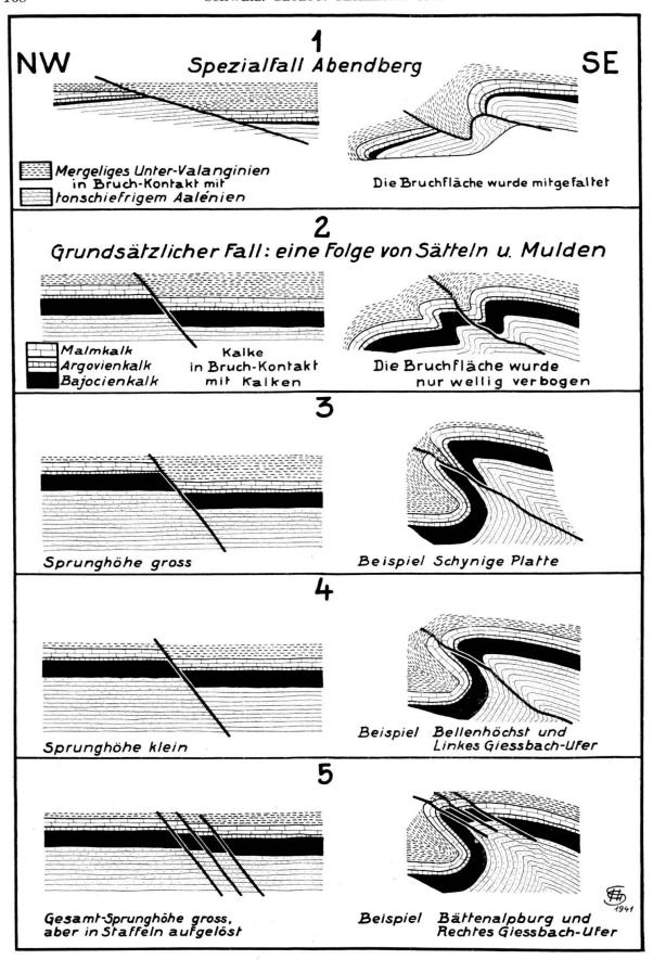
Fig. 1. Schemata von Verwerfungs-Systemen.
