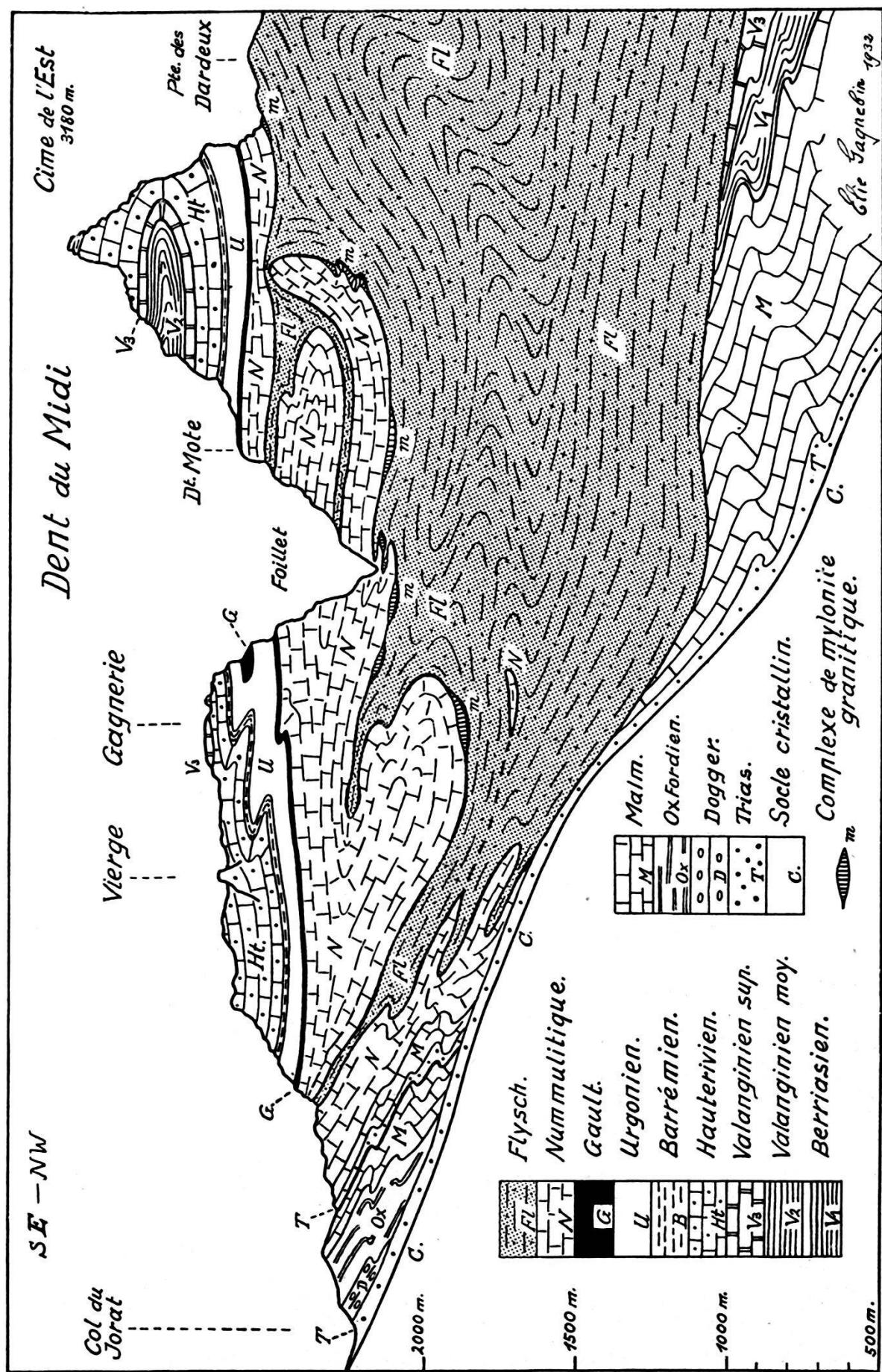
du plateau de Vérossaz ne permet aucun doute: c'est ici sur le Barrémien que transgresse le Nummulitique. Ce calcaire ne se retrouve ni au N de Vérossaz entre l'Urgonien et le Flysch, ni dans la direction de Mex sur les étages plus anciens. Il s'est donc déposé sur une surface précédemment arasée, et a été lui-même décapé avant la transgression du Flysch.
