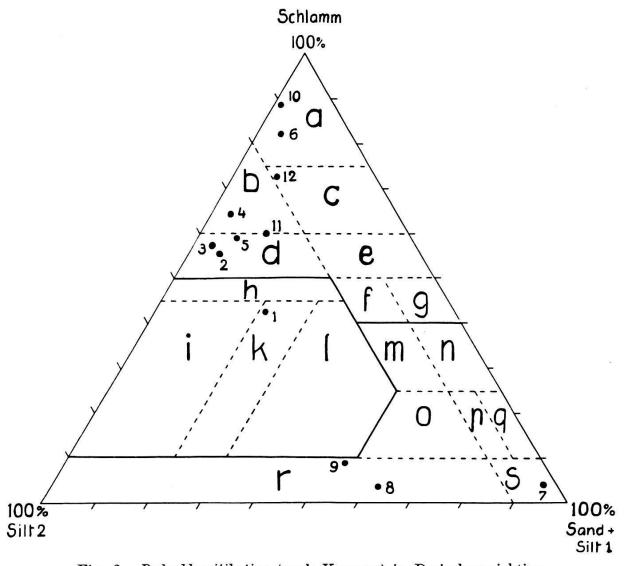
Fig. 2. Bodenklassifikation (nach Kopeky) in Dreiecksprojektion.
