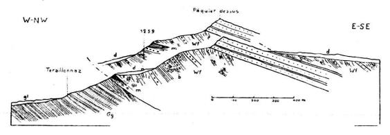
Fig. 2. Coupe schématique de la région des Paquiers (SW de la Berra). Wi = Wildflysch, b = blocs exotiques, m = lame de Malm, Gu = Grès du Gurnigel, Gg = Grès stampien de la Guiga (Molasse), gl = moraine, d = débris.
