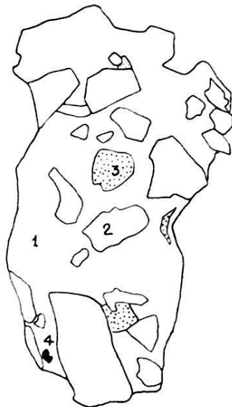
Fig. 23. Grain de phosphate de chaux (1) contenant du quartz (2), de la glauconie (3) et de la pyrite (4). Niveau 34. Gr. 25. Coupe mince M 53.
