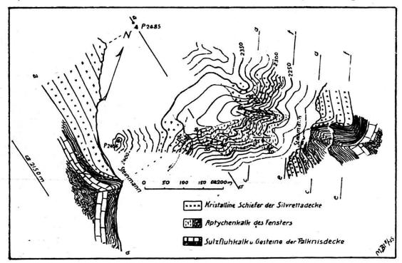
Fig. 7. Lageplanskizze und Profile des Fensters am St. Antönierjoch.
