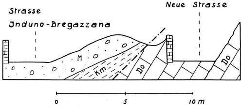
Fig. 8. Profil an der Strasse Induno-Bregazzana.  $M = \text{Mor\"ane}, \ Km = \text{Kreidemergel}, \ Do = \text{Dom\'erien}.$   $- \cdot - \cdot - \cdot - \cdot \text{Aufschiebung}.$
