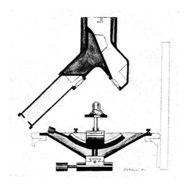
Fig. 4. Justiertisch und Kollimator-Fernrohransatz für Theodolith-Goniometrie.
