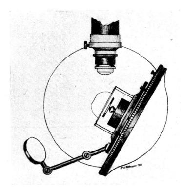
Fig. 3. Refraktometereinsatz mit stark lichtbrechender Halbkugel.
