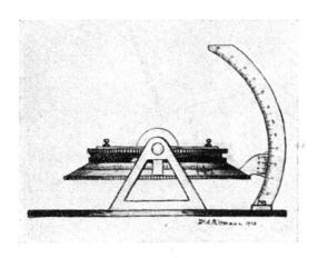
Fig. 2. Theodolithtischeinsatz mit Achsen N und H.
