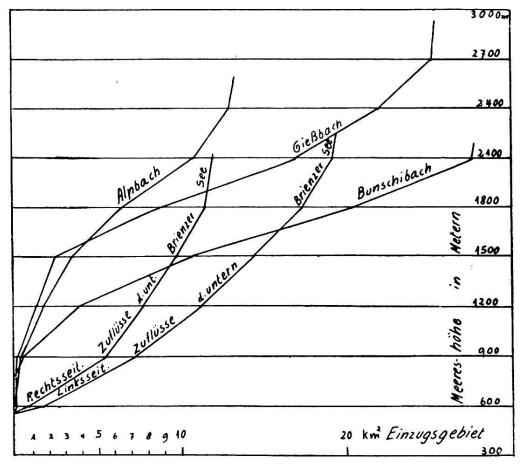
Fig. 1. Kurven zur Darstellung der Durchtalung.
