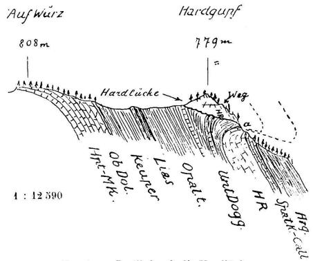
Fig. 4. — Profil durch die Hardlücke.
