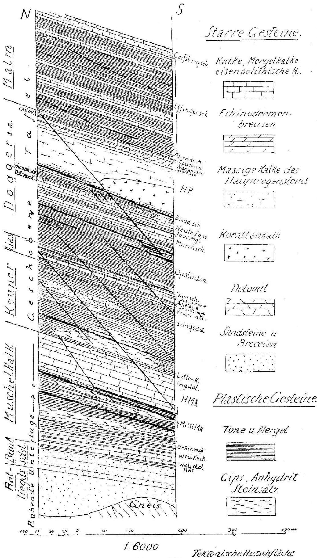
FIG. 1. — Schematisches Profil durch die Sedimentdecke im Staffelgebiet mit Rücksicht auf ihr Verhalten beim Schub.
