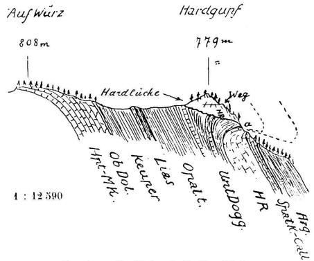
Fig. 4. — Profil durch die Hardlücke.
